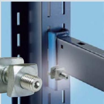
Durch Anziehen der Stellschraube wird eine gleichmäßige Vorneigung erreicht. Rundmaterial rollt so automatisch Richtung Ständer. Gleichzeitig wird eine feste Verbindung zwischen Kragarm und Ständerprofil hergestellt.
