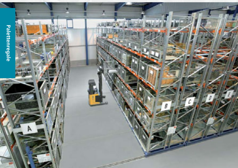
Die 7,4 m hohe, verfahrbare META MULTIBLOC® Palettenregalanlage bietet insgesamt 2190 Stellplätze
