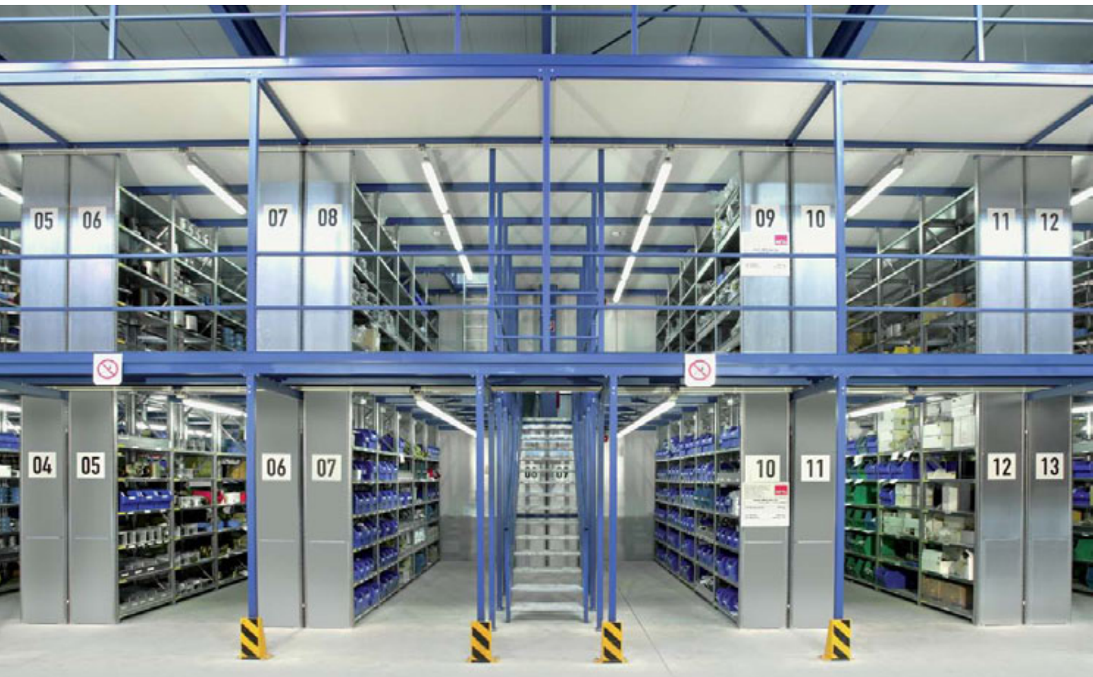
Beim Regionalversorger Mainova AG wurde eine 5,65 m hohe dreigeschossige META CLIP® Fachbodenregalanlage mit über 1600 Fachböden errichtet
