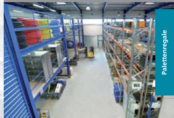
Fachbodenregale und verfahrbare Palettenregale wurden kombiniert, um eine optimale Lagerlösung für Mainova zu schaffen
